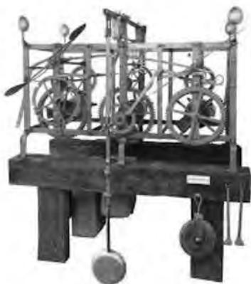
Механизм башенных часов
